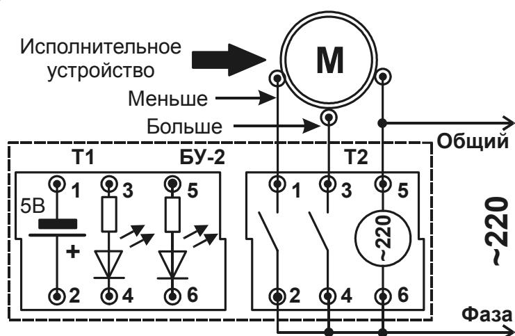
Вариант схемы подключения двух исполнительных устройств регуляторов через блоки БУ-2 к вычислителю ВКТ-5.
