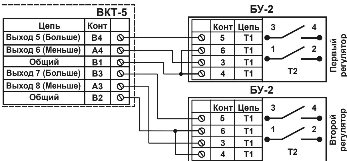
При подаче управляющего импульса с выхода 5(7) прибора ВКТ5 происходит замыкание контактов 3 и 4 первого (второго) блока, при подаче управляющего импульса с выхода 6(8) – замыкание контактов 1 и 2 первого (второго) блока.
