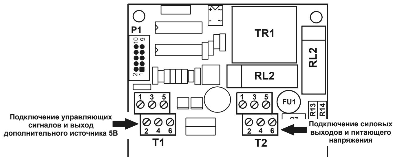
Все провода, необходимые для подключения блока, вводятся через гермовводы в нижней части корпуса, и подключаются к клеммным колодкам Т1 и Т2.
