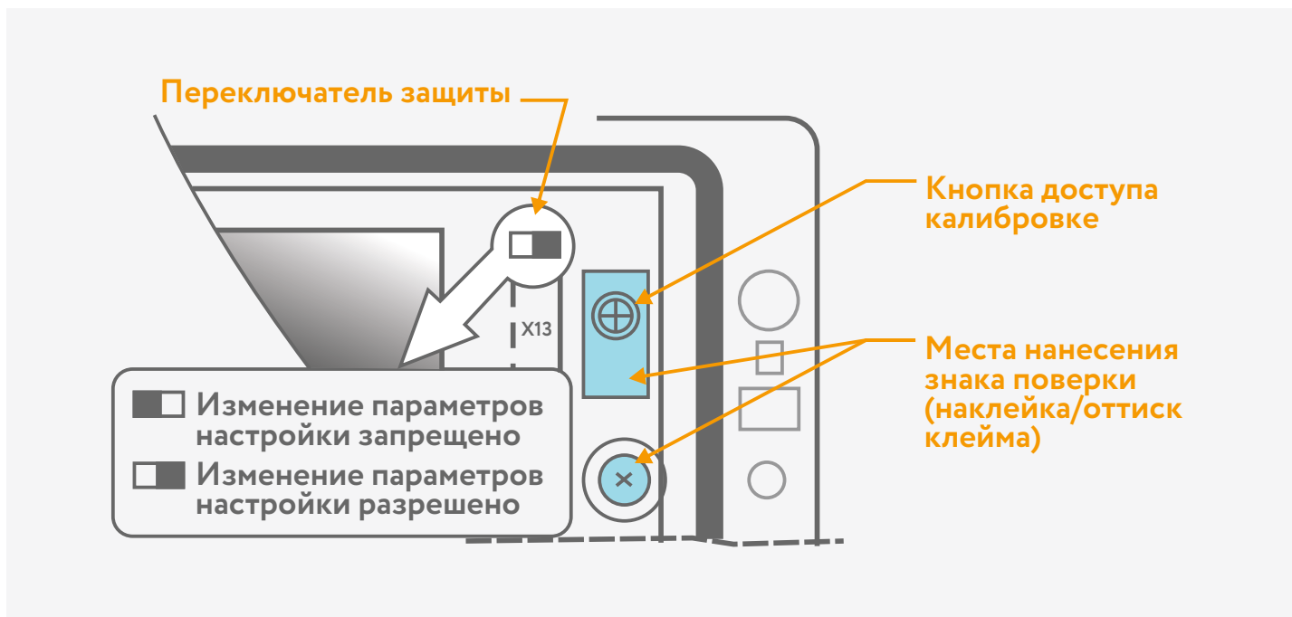
Рис. 1.2 – Места пломбирования поверителем
