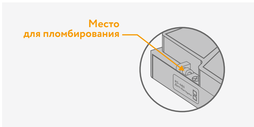
Рис. 1.3 – Место пломбирования инспектором
