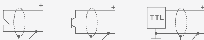
Виды выходных цепей датчиков расхода G1...G8
