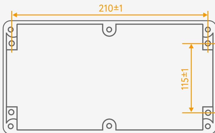
Рисунок 16 – Присоединительные размеры вычислителя
