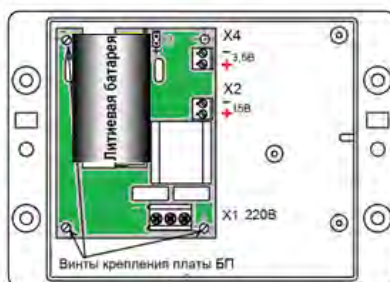
Рис.2 – Схема монтажа БП/ВКТ-7 в корпусе вычислителя
