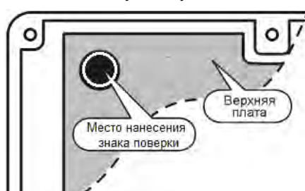
Рис. Д.4 Место нанесения знака поверки - на крепежный винт защитного каркаса электронного модуля (р.10.4 РЭ)
