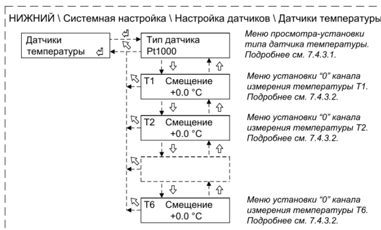
Рисунок 7 – Структура меню настройки датчиков температуры
