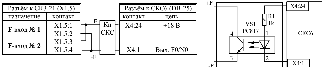
Рисунок Д.3.2 - Распайка разъёмов к СКС6 и подключение к разъёмам СК3-21 для подключения частотных сигналов
