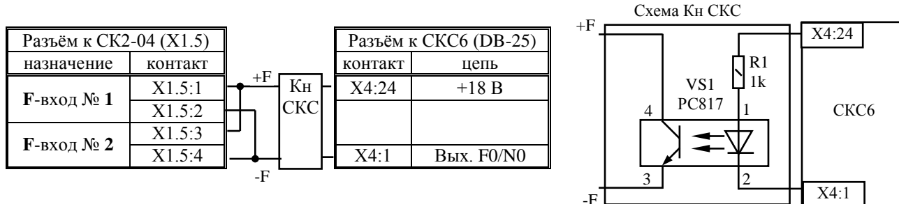
Рисунок Д.3.2 - Распайка разъемов к СКС6 и подключение к разъёмам СКЗ-13 для подключения частотных сигналов
