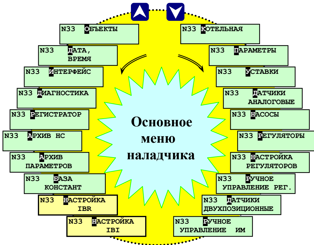
Рисунок 6.6.2.- Состав основного меню наладчика
