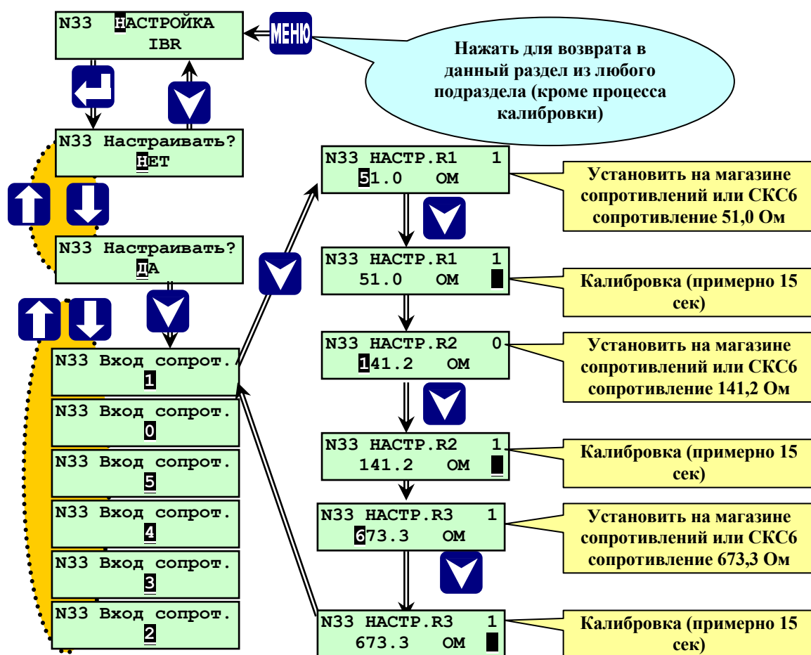
Рисунок 6.6.2.11- Раздел основного меню наладчика «Настройка IBR»
