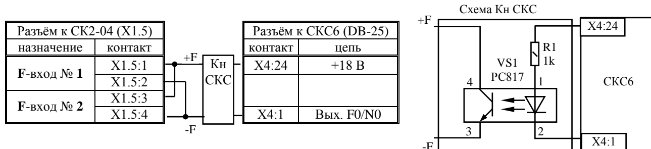
Рисунок Д.3.2 - Распайка разъемов к СКС6 и подключение к разъемам СКЗ-13 для подключения частотных сигналов
