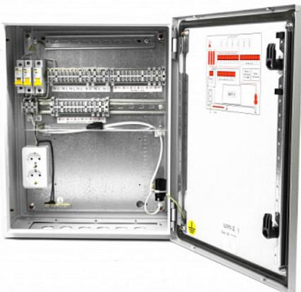
Шкаф выполнен на основе универсального монтажного шкафа. Внутри располагаются металлическая монтажная панель, пластиковая крышка для защиты элементов питания приборов от несанкционированного вмешательства, технологические розетки. Все монтажные коммуникации проводятся через гермовводы FN 2606-26G, находящиеся на нижней стороне корпуса и предназначенные для использования с гофрированными трубами диаметром до 26 мм.
