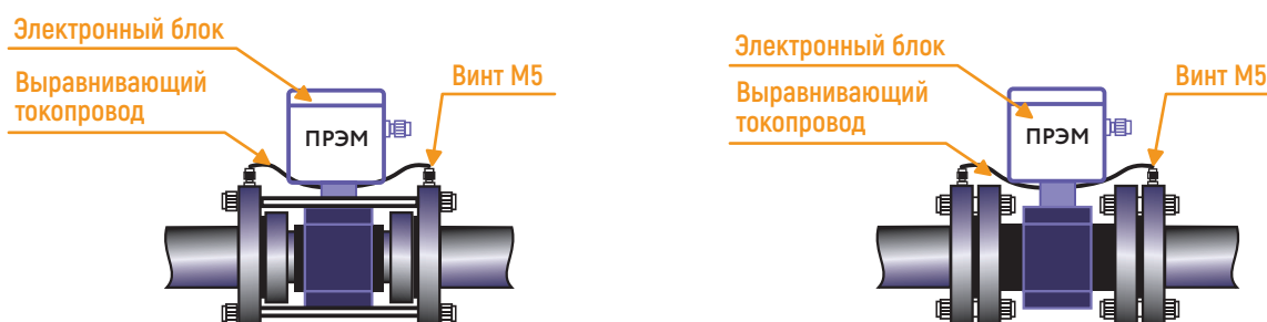
Рисунок 21. Выравнивание потенциалов для металлических токопроводов
