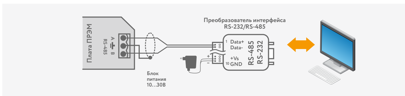
Рисунок К.4 – Схема подключения к ПК через интерфейс RS-485
