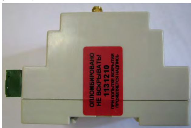
Рисунок 3.31 – Наклейка пломба на МПД-1
