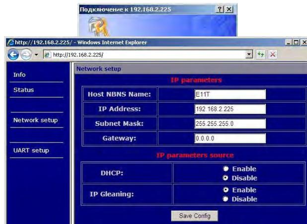
3.9 Ввести пароль. Настройки «IP parameters source» должны соответствовать указанным на рисунке. Для сохранения параметров нажать «Save config» (кнопку на адаптере нажимать необязательно).
